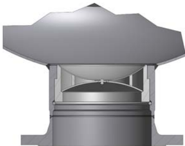
Beispiel: Vorschweißflansch Example: Welding neck flange
