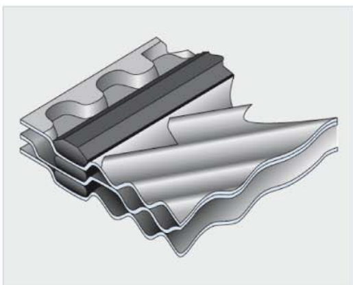
Bei allen anderen Platten sind die Dichtungen in angeschrägten Nuten.
