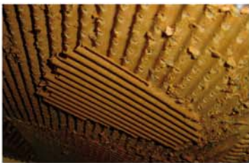
Verunreinigungen erhöhen den Druckabfall und die Energiekosten. Auch können die Platten und Dichtungen dadurch beschädigt werden.
